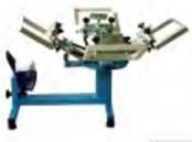
**Cap-Handdruckgerät als Tischdruckgerät**
