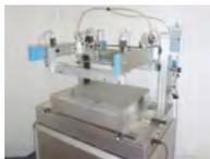
**ROKUPRINT Siebdruckmaschine RPZ 500 für Flachdruck**
