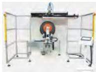
**Halbautomatische Siebdruckmaschine TIC SC1000 OptiPass**
