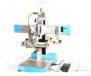
**Pneumatisches Rakelwerk für ROKUPRINT SD 05/2.1**
