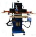
**Halbautomatische Siebdruckmaschine Mod. TIC SFM 650 DHE**
