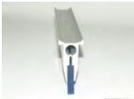
**Druck rakel für Siebdruckmaschine SIRIMAC mit Rakelgummi**
