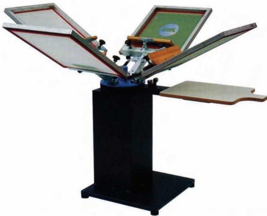
Handdruckgerät für Textilien, T-Shirts, Wimpel etc.
