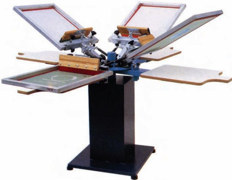
Handdruckgerät für Textilien, T-Shirts, Wimpel etc.
